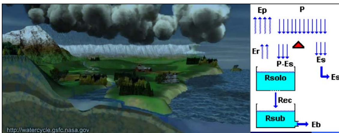
Figura 3.1.1. Diagrama esquemático do Ciclo Hidrológico no Modelo SMAP.
